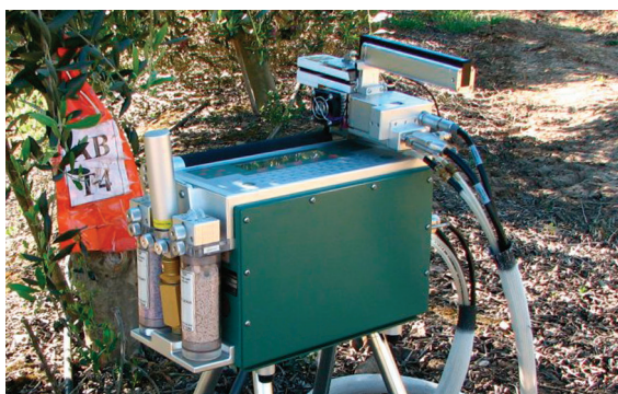
Medición del intercambio gaseoso usando un analizador infrarrojo de gases Licor-6400
