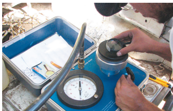
Medición de estado hídrico de planta mediante una cámara de presión tipo Scholander
