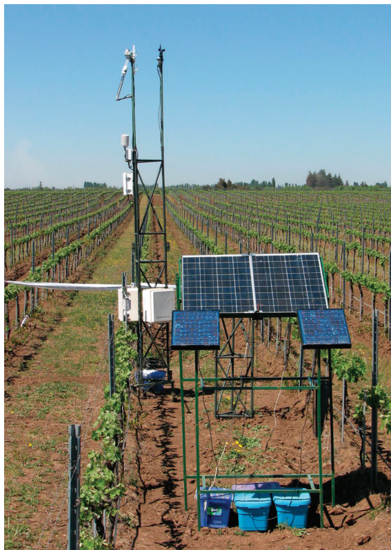
Estación micrometeorológica de alta precisión
