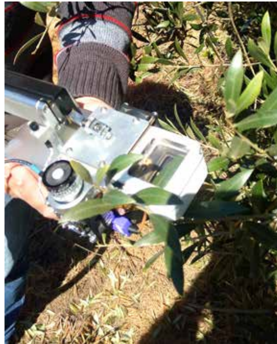
Medición del intercambio gaseoso usando un analizador infrarrojo de gases Licor-6400 en un olivar
