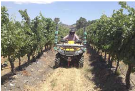
Termometría infrarroja lateral del dosel del viñado.
