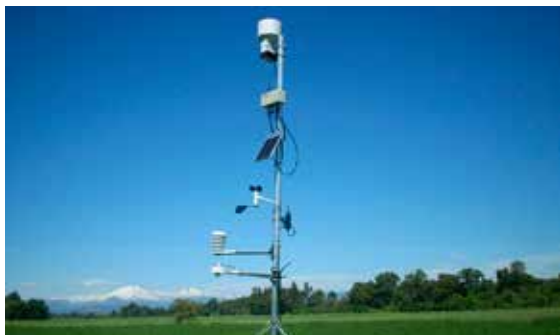
Estación meteorológica automática sobre una cubierta de alfalfa.
