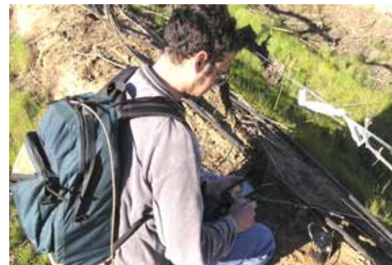
Medición de humedad de suelo utilizando un TDR.
