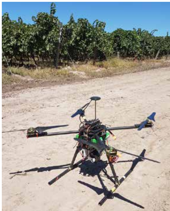
Vehículo aéreo no tripulado utilizado para estimar índices de vegetación en un viñado.
