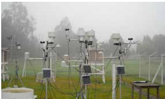
Calibración de sensores meteorológicos.
