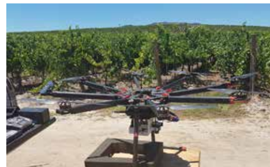
Utilización de un vehículo aéreo no tripulado para mediciones multiespectrales y termales.
